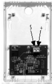
Płytkę połączeń elektronicznych czujnika %RH Przewód elektryczny: 2 x 0,5 mm 2
